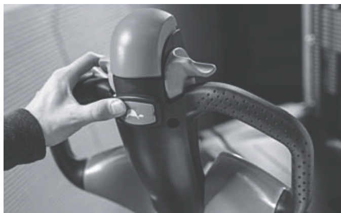
Точность в любой ситуации: с помощью режима медленного хода возможно маневрирование даже в узких помещениях
