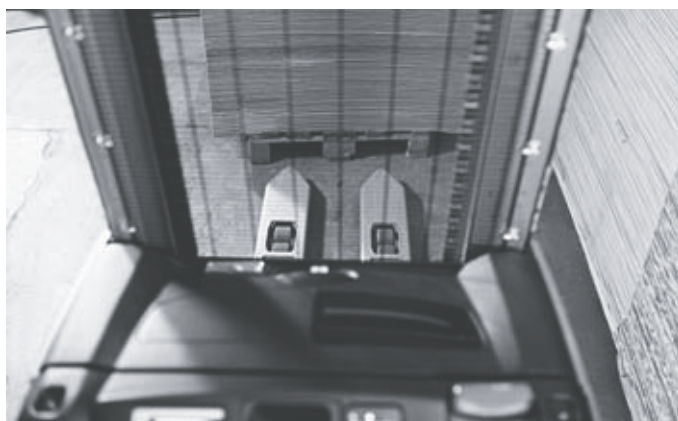
Постоянный хороший обзор кончиков вилок благодаря просматриваемой подъемной мачте STILL
