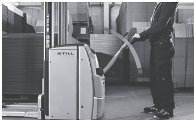
Безопасность: в зависимости от угла положения дышла скорость движения автоматически адаптируется к расстоянию между оператором и тележкой
